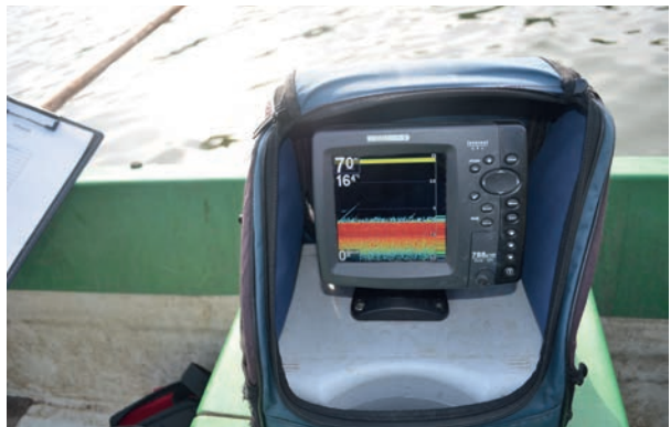
Abbildung 16: Mit Hilfe eines Echolots wurde die tiefste Stelle im See für die Erstellung eines Sauerstoff-Tiefenprofils gefunden.
